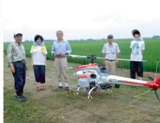
防除用のラジコンヘリ。1日35ヘクタールの防除をするそうです。お値段なんと1千万円以上…(>_<)
