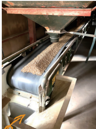
乾燥されたお米を籾摺り機に送ります。その後、袋詰めされ、米穀検査を受けます。
