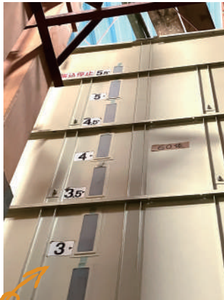
見上げるほど高い乾燥機。米70俵(4,200kg)を一気に乾燥できます。
